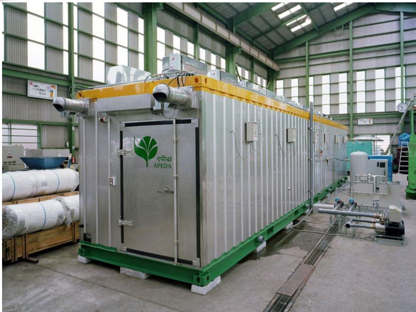
出口检疫昆虫和微生物熏蒸室
